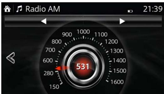
Sin embargo, los coches eléctricos no suelen equipar una radio que admita frecuencias AM, pero sí FM y DAB. La razón es porque el campo electromagnético de los motores eléctricos interfiere con la recepción de las emisoras en AM.
