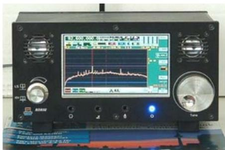
68098.- En elradioescucha.net conocemos el pequeño receptor de emisoras RDR52 es un receptor de Onda Corta configurable con opciones para la recepción FM / 2 m / DAB(+) y el funcionamiento del transceptor.
